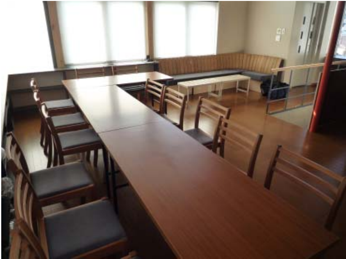
リビング 完成 (仕上げ材:無垢フローリング 厚み 15mm)
