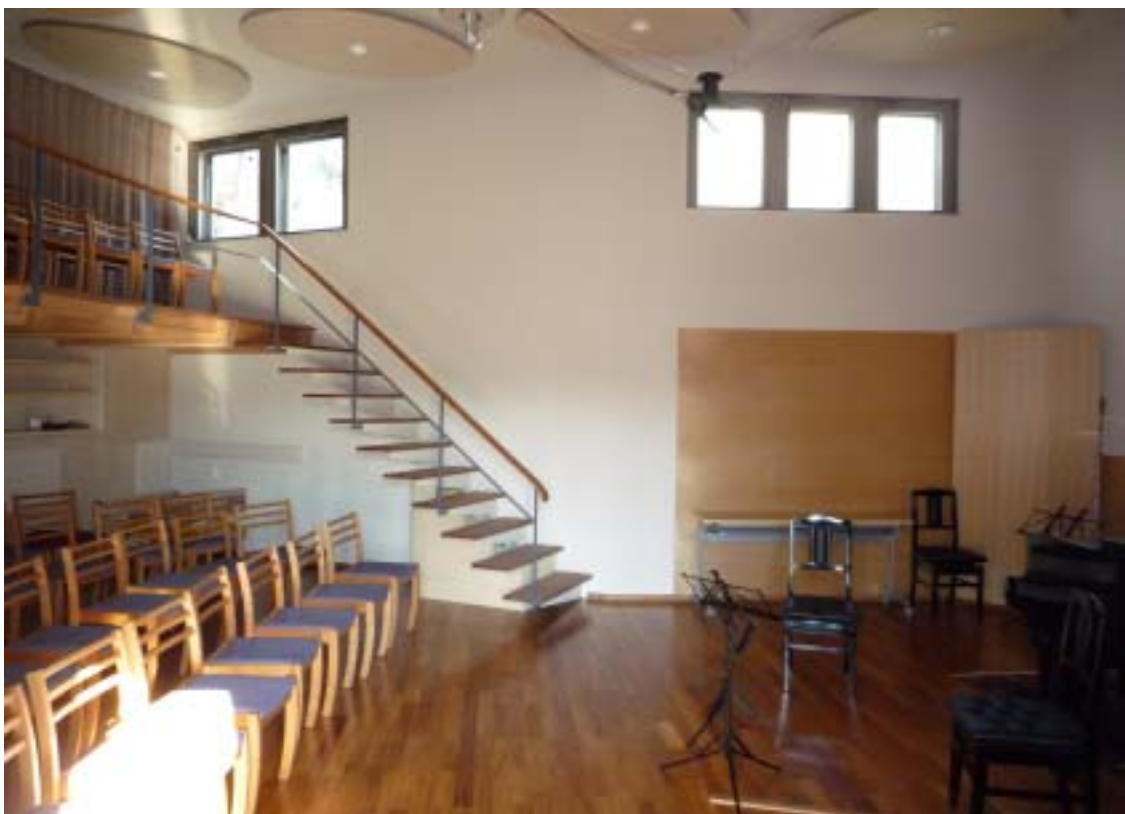
音楽室 完成 (仕上げ材:無垢フローリング 厚み 15mm)
